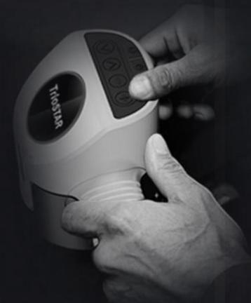
最初に、出力ヘッドの赤色ライトボタンを押し、その後、有効化スイッチを押し続けてライトを点灯させます。赤色ライトを点灯させてから2分以内に操作が行われない場合、自動的に赤色ライトが消灯し、装置は待機状態になります。
